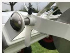
Ergot métallique sur les bras des disques pour une meilleure stabilité lors de la levée de la machine.
