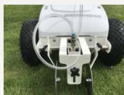
Disques réglables en largeur pour ajuster vos traçages et la buse en hauteur par des vis papillon.
