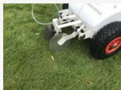
Disque avant sur axe oscillant suivant les déformations de vos terrains, largeur régulière.
